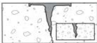
Reparação de fissuras e juntas de controle ou retração
