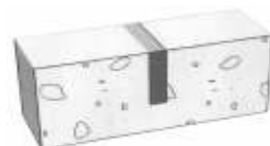
Detalhe 3: Enchimento completo, em toda a profundidade para máxima protecção e em condições de tráfego pesado constante.
