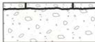
Delaminação em placas de betão
