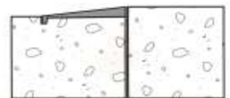
Desnivelamento em placas de betão
